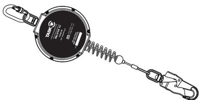
Dispositivo trava quedas retrátil com 10m de cabo de aço de 4mm com resistência de 14kN e conectores de aço. Carcaça construída em plástico de alta resistência. Deve ser utilizado em conjunto com o cinturão de segurança tipo para-quedista.
